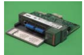
Allen Bradley SLC500 Module
